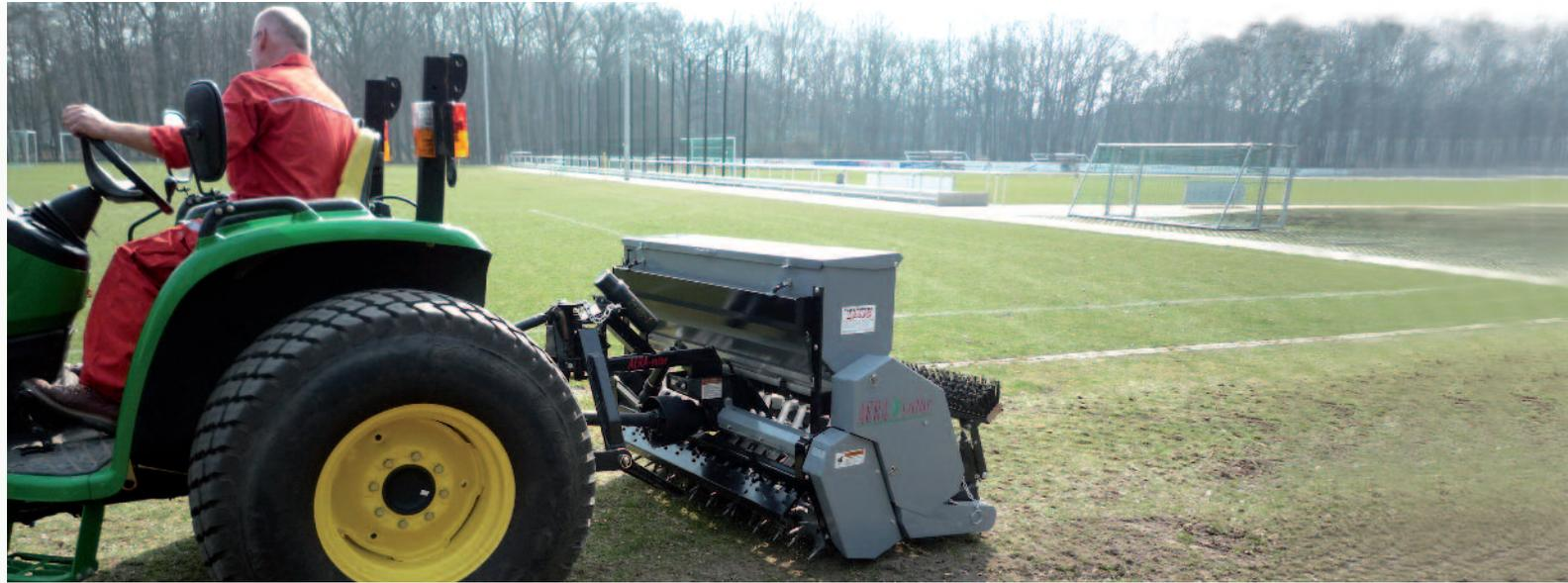
Boden lockern und gleichzeitiges Einbringen von Bodenverbesserer
